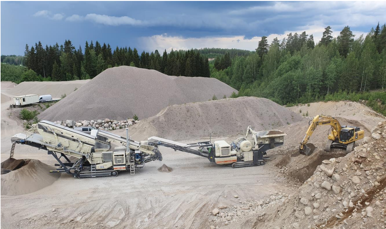
Kuva 19. Liikuteltava tela-alustainen murskauslaitos kokoonpano, jota käytetään murskaustoiminnassa.
