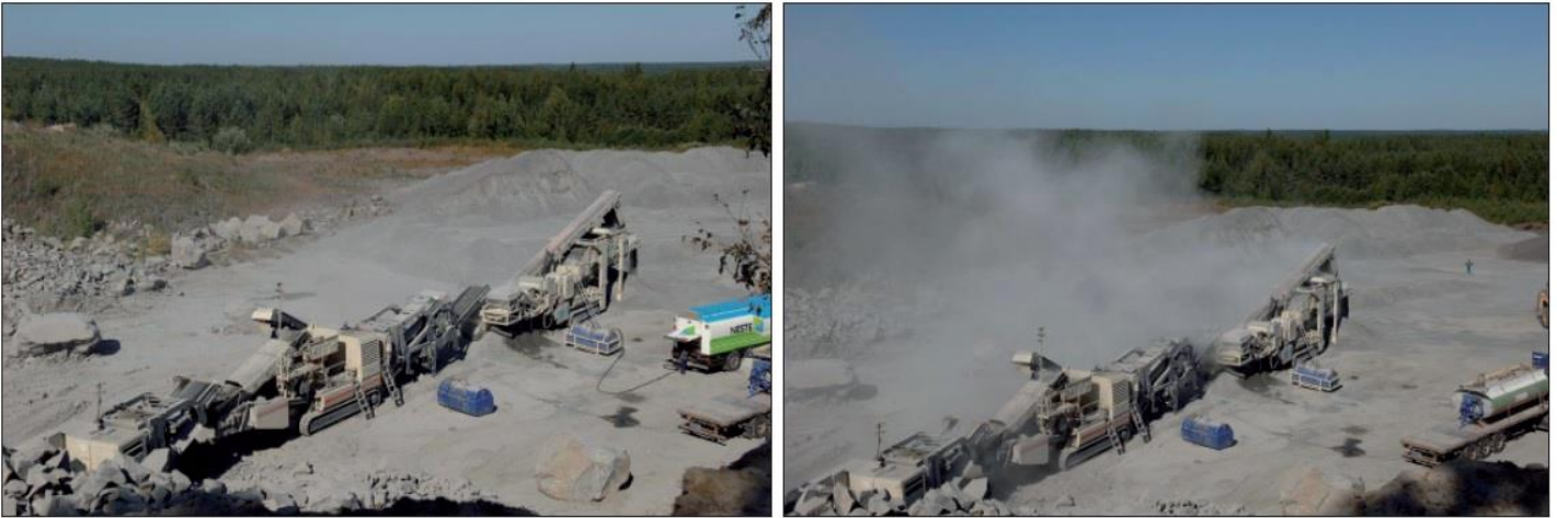
Kuva 20. Vesikastelun vaikutus pölyn syntymiseen murskauksessa. (Kuva: Metso 2010, Suomen ympäristö 25/2010)
